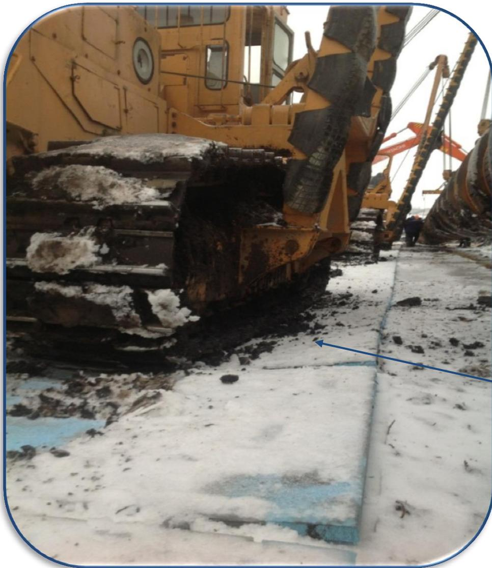
В процессе движения семи трубоукладчиков при протаскивании трубопровода боковое скольжение техники не зафиксировано.
